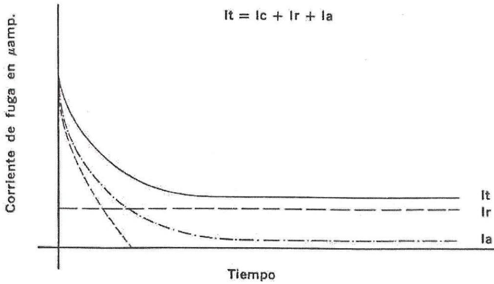
FIG. 12.4 VARIACIÓN DE LA CORRIENTE DE FUGA  $I_T$  EN EL TIEMPO, PARA UN CABLE DE POTENCIA
