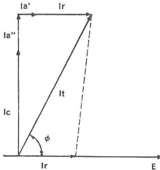
FIG. 12.3 DIAGRAMA VECTORIAL PARA UN CABLE DE POTENCIA
